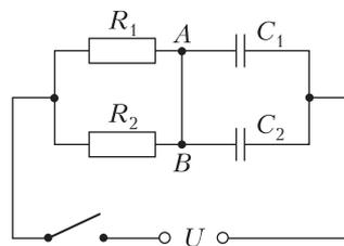
Какой заряд  $\Delta q$  протечет через проводник  $AB$  за достаточно большой промежуток времени после замыкания ключа, если конденсаторы были первоначально разряжены?
