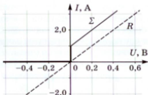
6. На графике (см. рисунок) приведена зависимость силы тока, текущего через автомобильную лампочку от напряжения на ней. Лампочку подключают к источнику постоянного напряжения  $U = 10$  В последовательно с резистором, имеющим сопротивление  $R = 4$  Ом. Определить мощность лампочки.
