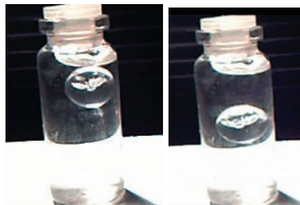
Шарик опускается, если обдуть пузырьком горячим воздухом, и поднимается, если холодным
